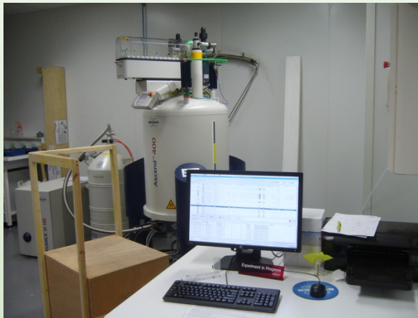
RMN 400 MHz « liquide » de routine avec crysonde azote et passeur d'échantillons
