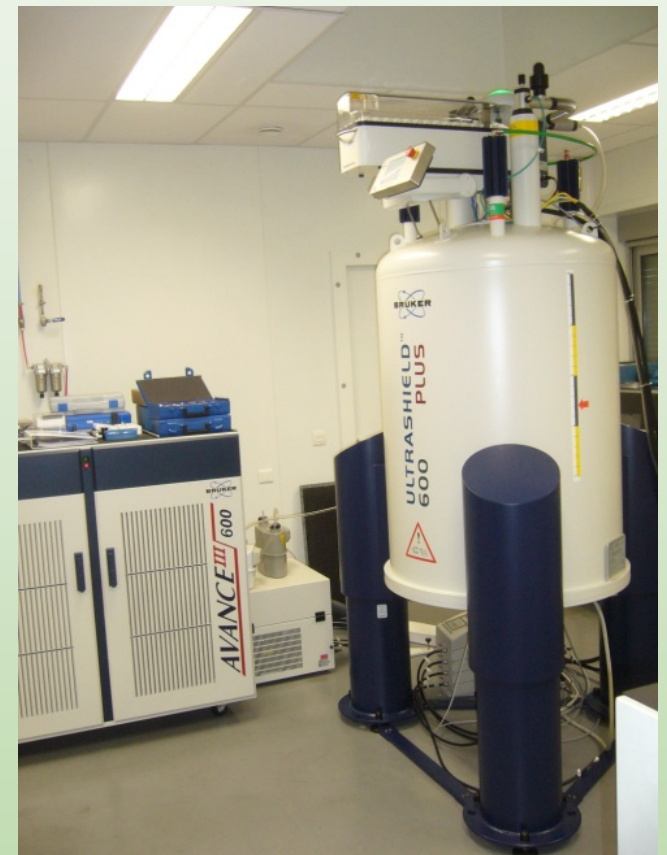
RMN 600 MHz « liquide » multi-sondes et passeur d'échantillons
